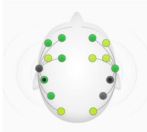
ภาพที่ 2.7 เครื่องบันทึกคลื่นไฟฟ้าสมองแบบพกพา 14 ช่องสัญญาณ ( https://www.emotiv.com/epoc/ )
