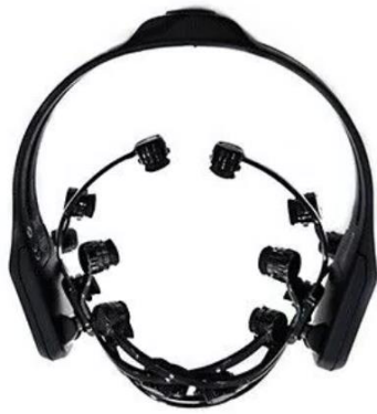
ภาพที่ 2.7 เครื่องบันทึกคลื่นไฟฟ้าสมองแบบพกพา 14 ช่องสัญญาณ ( https://www.emotiv.com/epoc/ )
